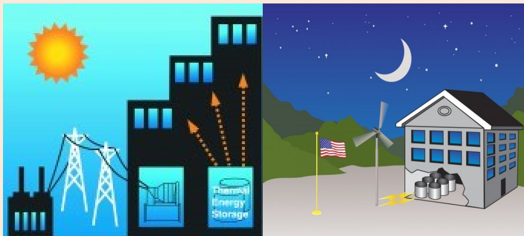
Slika 12: Koriščenje energije podnevi in proizvodnja ledu ponoči
